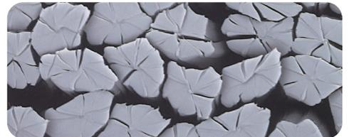
マイクロファイバー断面図 顕微鏡 1500倍率
